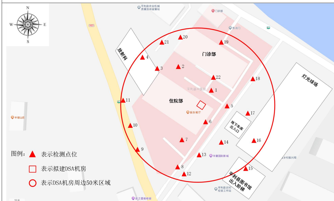
图 8-7 机房周边 50 米区域检测点位图
